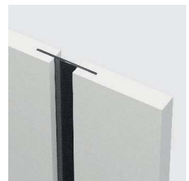
łączenie z szybą „na kant” skrzydło bezprzylgowe
